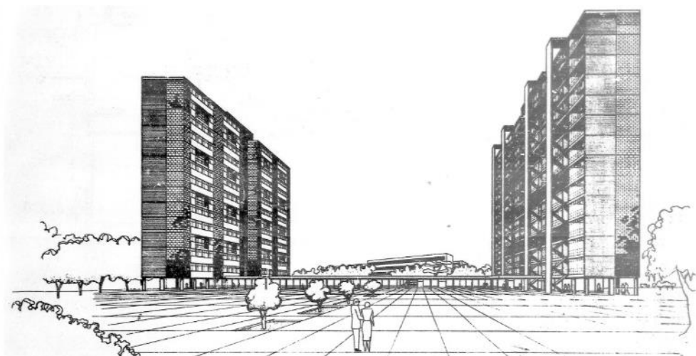
Figura 103: Perspectiva de los edificios multifamiliares tipo “B”, de la tesis de Miguel de la Torre Carbo, 1955. Se aprecia la escala de los inmuebles de 14 niveles, intercomunicados por andadores cubiertos.
