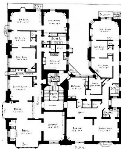
Figura 46: Planta y fachada de un edificio arquetípico de apartamentos neoyorquino de finales del siglo XIX, The berkshire apartment house , ca. 1888. Diseñado por el arquitecto Carl Pfeiffer.
