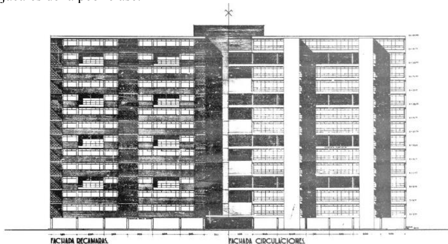
Figura 104: Alzado de las fachadas de un edificio multifamiliar tipo “B”, de la tesis de Miguel de la Torre Carbo, 1955. El dibujo hábilmente esta partido al centro geométrico, mostrando en cada una de las mitades media cara de fachadas opuestas. Del lado izquierdo, la fachada por recámaras y del derecho, la fachada por circulaciones.
