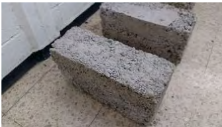
Ilustración 21: Prototipo de block reciclado realizado por el proyecto RENOVUS
