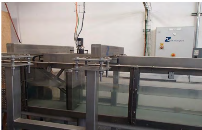
Figura 4.2 Pala generadora de oleaje
