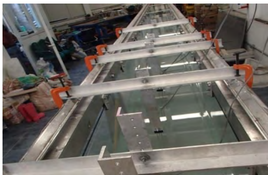
Figura 4.15 Colocación de los sensores de nivel
