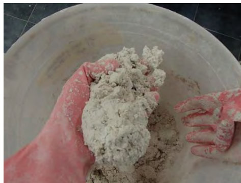
Figura 4.12 Premezclado del caolín y agua
