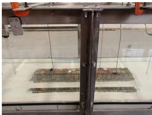
Figura 4.14 Estructura- suelo, en el canal de oleaje
