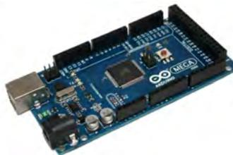
Figura 4.3: Microcontrolador Arduino Mega utilizado como tarjeta de adquisición de datos
