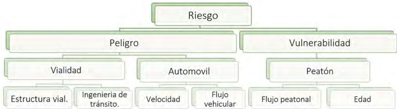
Figura 4. componentes de riesgo peatonal. Elaboración propia.
