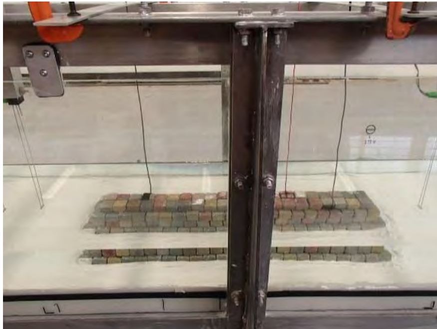
Figura IV. 18 Estructura, suelo en el canal de oleaje.
