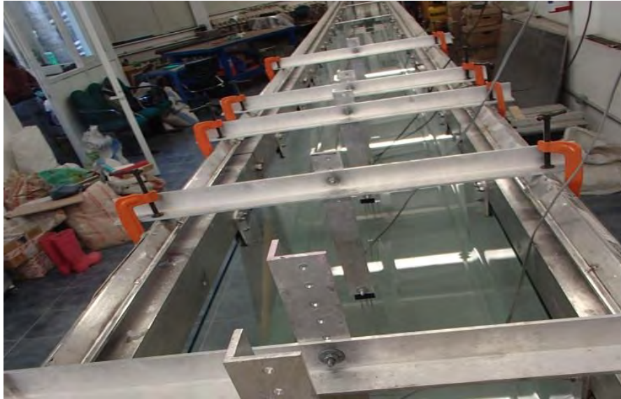
Figura IV. 19 Colocación de los sensores de nivel.
