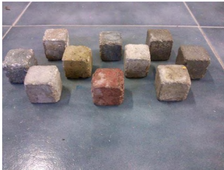
Figura IV. 14 Cubos de concreto.
