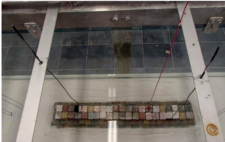
Figura V. 13 Medición del hundimiento, alambre-riel.
