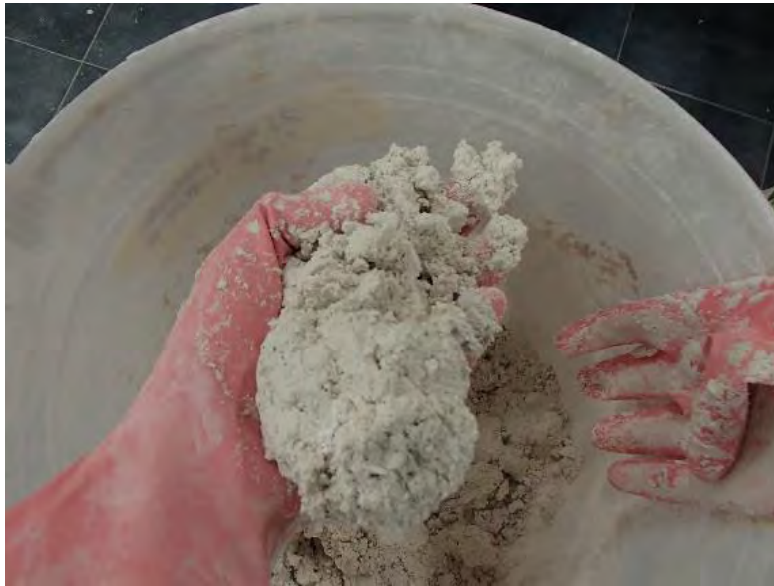
Figura IV. 16 Premezclado del caolín y agua.
