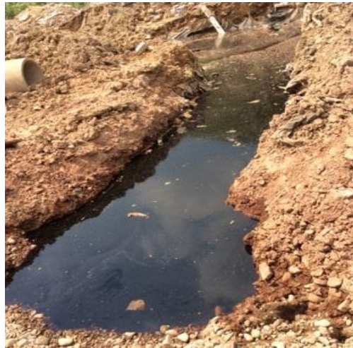
Figura 3. 8 Filtración de lixiviados en el subsuelo Fuente: Proporcionada por Ing. Antonio Jacintos Nieves
