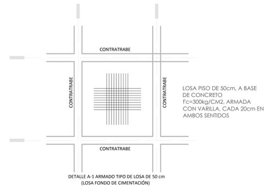
DETALLE A-1 ARMADO TIPO DE LOSA DE 50 cm (LOSA FONDO DE CIMENTACIÓN)
