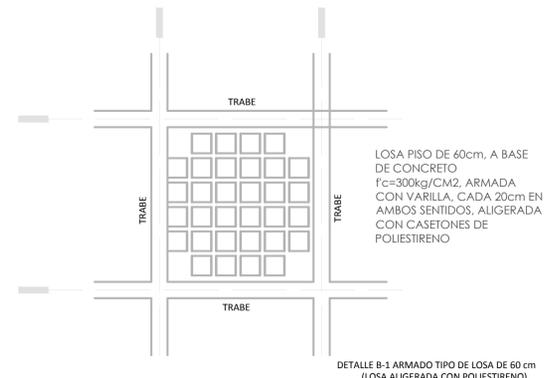
DETALLE B-1 ARMADO TIPO DE LOSA DE 60 cm (LOSA ALIGERADA CON POLIESTIRENO)
