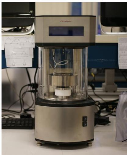
Figura 21. DCAT 11, equipo para medir tensión superficial por el método de la placa de Wilhelmy.
