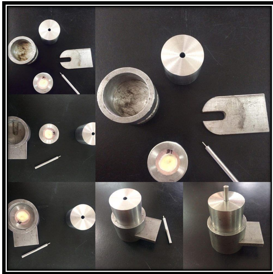
Fig.018 colocacion de la muestra en el aditamento para la pruebas de resistencia.
