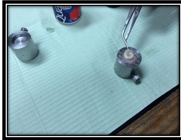
fig.006 montaje de las muestras enacrílico.
