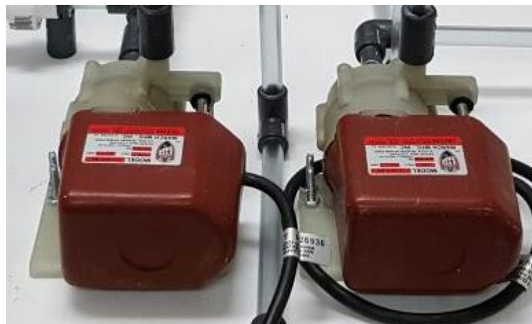
Fig. 4.12 Bombas de 1/4 de hp
