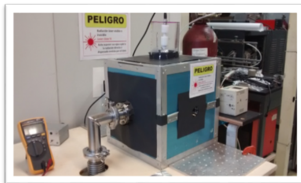
FIGURA 2.13: Imagen del arreglo experimental para las mediciones de efecto optogalvánico en configuración de placas paralelas.
