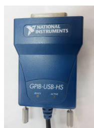
FIGURA 2.7: GPIB utilizada para capturar los valores de longitud de onda del QCL en la computadora.
