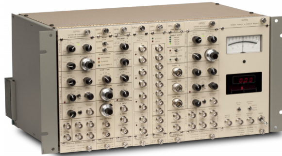
FIGURA 2.5: Boxcar averager modelo SR280 utilizado para la adquisición y análisis de los datos obtenidos por el MCT.
