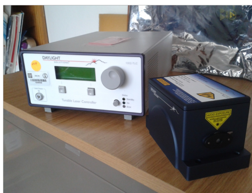
FIGURA 2.2: Arreglo experimental utilizado para la adquisición del espectro de absorción de vapor de agua en el ambiente utilizando el QCL y el MCT. TL: Trigger del láser usado como referencia para el boxcar. LR: Longitud de onda del láser. Comp.: computadora usada para la adquisición de datos mediante la DAQ.
