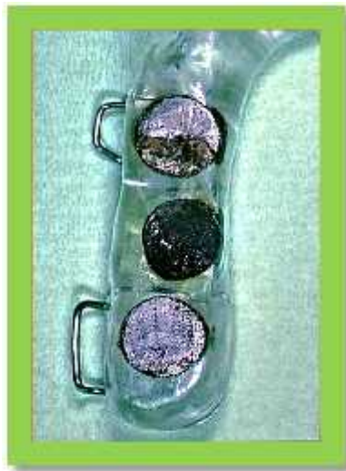
Fig. 45 Desgaste y corrosión de dos imanes de samario-cobalto y uno de neodimio-hierro-boro. 7
