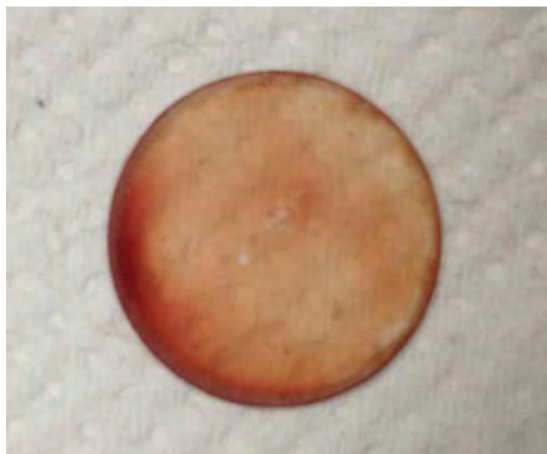
Figura 5.4 Muestra de sangre preparada para la medición (ya colocada entre dos cubreobjetos).
