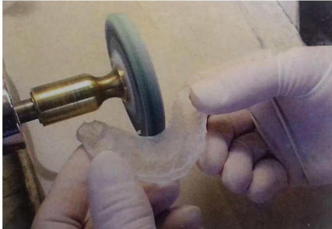
Figura 28 . Se recorta y elimina el exceso de material acrílico que cubre el tejido con una rueda de goma dura en un torno.
