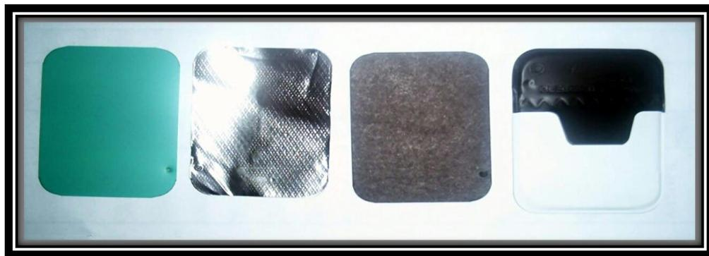
Figura 9 Componentes de la película radiográfica.<sup>16</sup>
