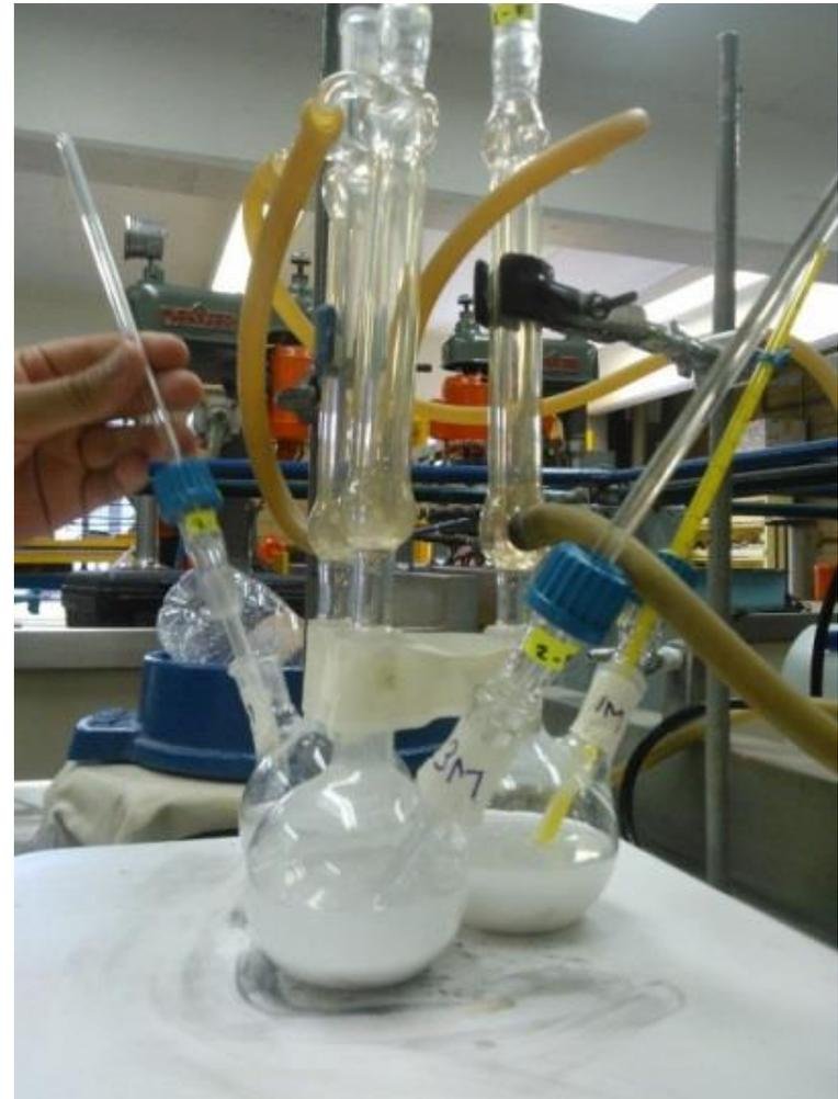
Fig. 3-4 Sistema de lixiviación ácida. 3 matraces de bola de 100 ml con termopozos y columna de condensación conectada en serie.
