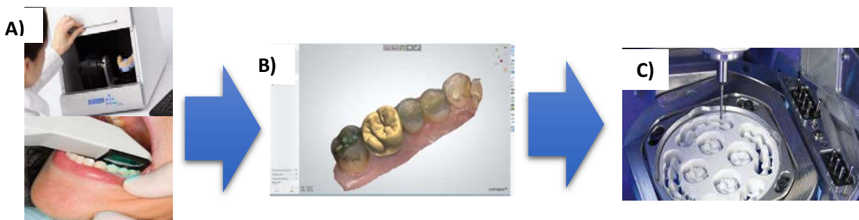
Figura 37 - Fases del CAD/CAM en Odontología: A) Digitalización. B) CAD (Diseño Asistido por Computadora). C) CAM (Manufactura Asistida por Computadora).
