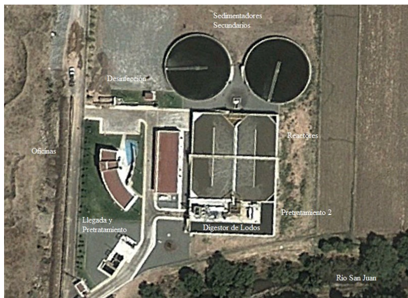
Figura 8.4 Esquema general de las unidades de tratamiento de la planta
