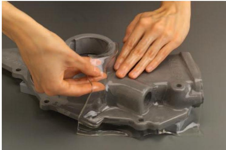
Figura 1-5. Colocación de película foto elástica sobre la superficie de una bomba de agua de un auto [12].
