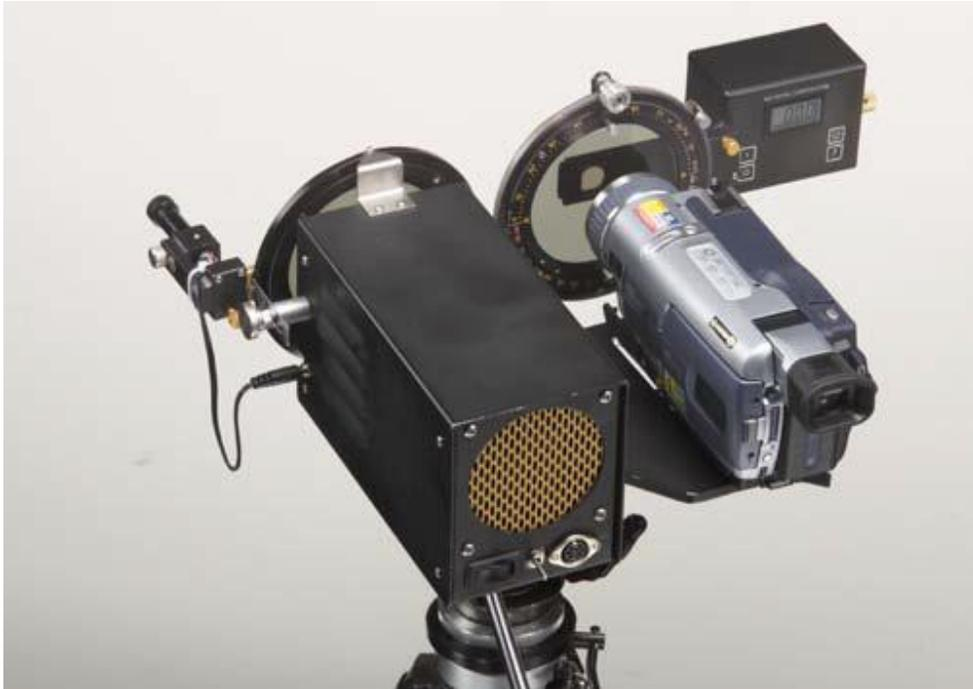
Figura 1-10. Polariscopio de reflexión [12].
