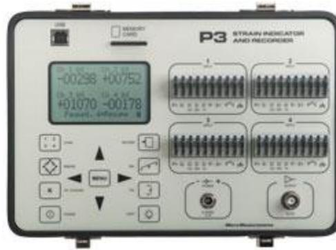
Figura 1-8. Indicador de deformaciones portátil [14].
