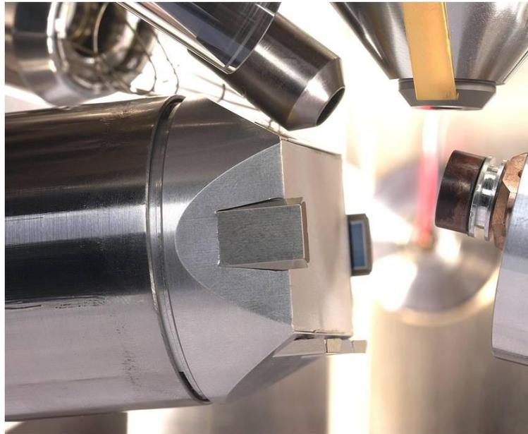
Figura 2-19. Arreglo de la muestra una muestra para medir su orientación cristalina usando la técnica EBSD [34]
