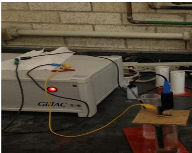
**Figura 5.4** Celda conectada al equipo Gill AC para realizar Espectroscopía de impedancia electroquímica
