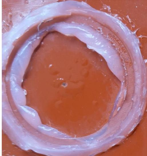
**Figura 6.30-** Placa Dañada inmersa en la mezcla de los dos medios corrosivos 3% p/v NaCl mezcla 0.07 % p/v  $(\text{NH}_4)_2\text{S}$
