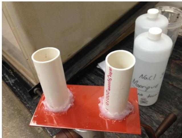
**Figura 5.3** Placa perfecta con los tubos pegados con silicón y electrolito
