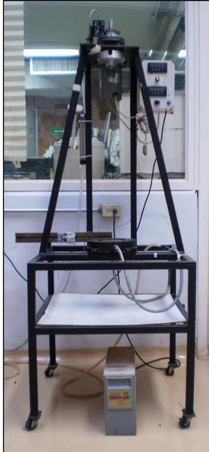
Figura 5.16. Sistema de motor y cojinete neumático usados en la medición de potencia.
