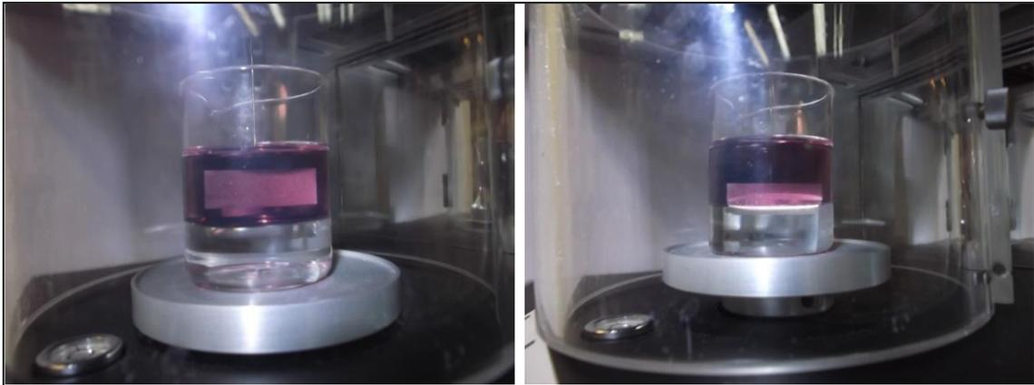
**Figura 5.12. Determinación de tensión interfacial por el método de placa Wilhelmy (para estas fotografías se usó un fluido coloreado de baja densidad con fines demostrativos).**
