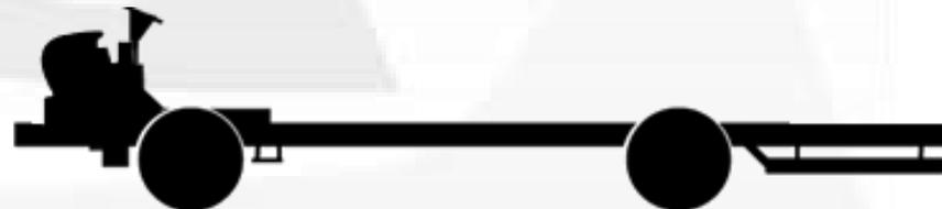
Este tipo de configuraciones son las más comúnmente usadas en el transporte público en la Ciudad de México, sobre el chasis se monta la carrocería teniendo así la función de autobuses para pasajeros de igual forma este tipo de chasis a excepción del de motor trasero pueden funcionar como camiones de trabajo por la facilidad de configurar cualquier tipo de carrocería.
