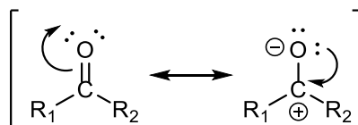
Figura 4: Estructuras resonantes del grupo carbonílico
