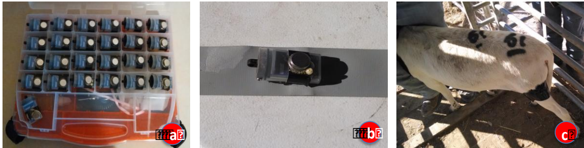
Fig. 2. De izquierda a derecha: a) Estuche con los dispositivos usados en el estudio, b) Dispositivos adheridos el uno al otro y la cinta antes de ser colocados; c) Los dispositivos ya adheridos en los animales en el miembro posterior izquierdo.
