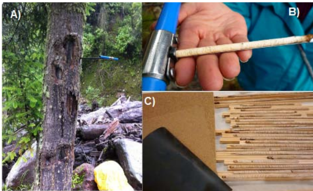
Figura 3.13: Mosaico de fotografías de colecta de muestras en Barranca de Nexpayantla y procesamiento (fotografías de Osvaldo Franco-Ramos y Citlali Salas, 2013). A) Extracción de un núcleo con barreno Pressler en árbol con cicatrices de impacto por flujos de agua y sedimento, B) núcleo de árbol muestreado y C) registro de núcleos y pulimiento
