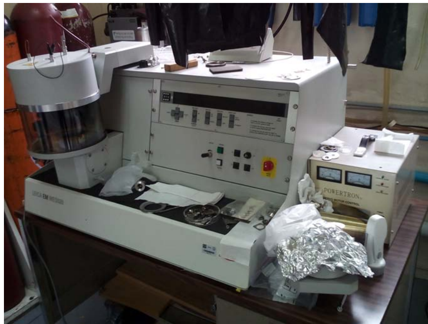
Figura 4.3: Cámara de sputtering usada para el depósito de ZnO.
