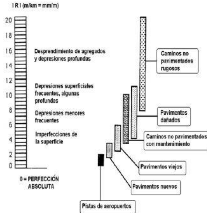
Ilustración 22 Escala del IRI, según el Banco Mundial
