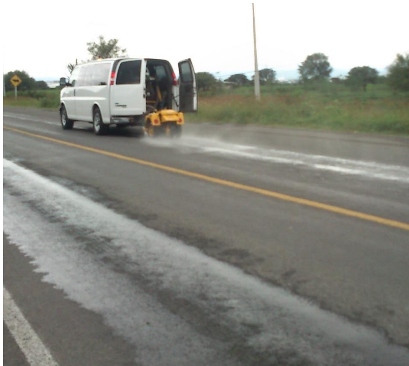
Ilustración 12 Evaluación del coeficiente de fricción mediante el equipo Mu-Meter
