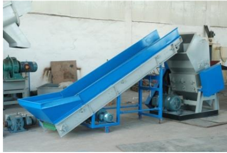
Fig.12 Cinta transportadora con molino ( http://www.maquinariadereciclaje.com ).
