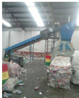
Fig. 6 Centro de banda con ponchadora integrada y empaquetadora (foto inédita).
