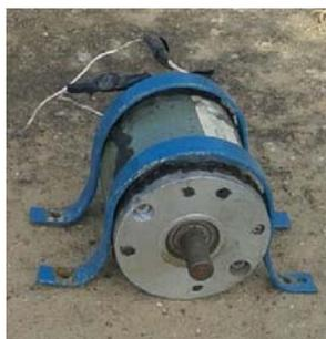
Fotografía 40. Abrazaderas para el aerogenerador.
