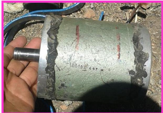
Fotografía 16 y 17. Generador y sellado con silicón.
