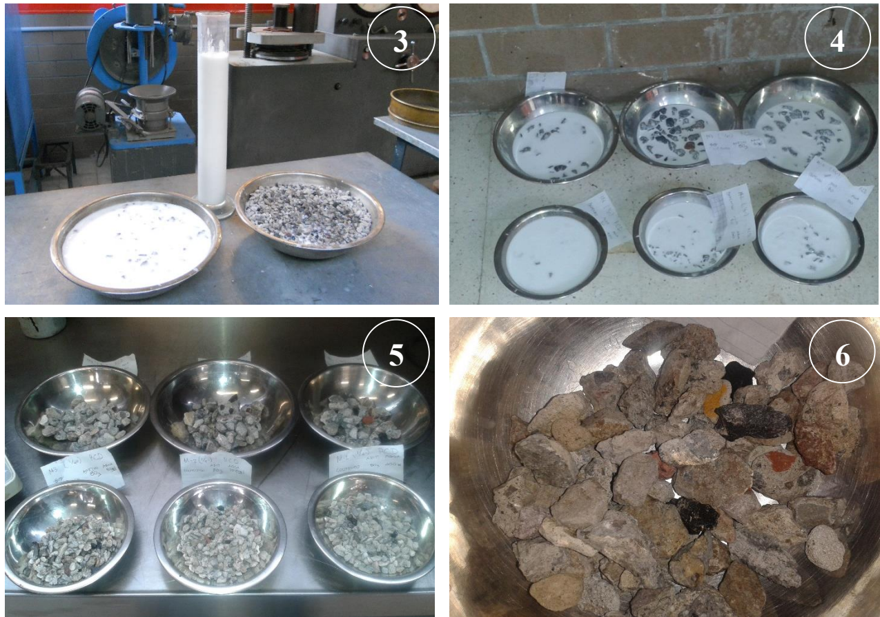
Figura 20. Por cada prueba con diferente proporción de “Sellador vinílico – acrílico” se realizó una inspección visual de cada agregado, observando que la película cubriera uniformemente y tuviera una apariencia consistente
