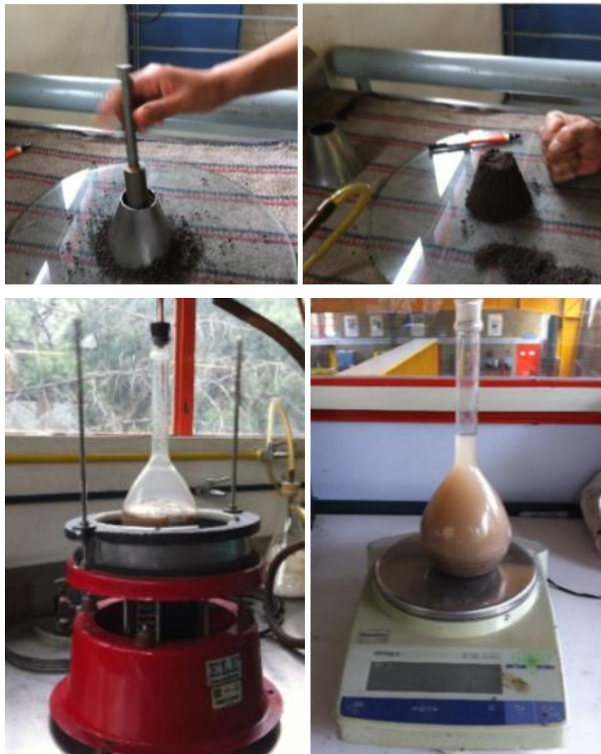
Figura 28. Ensayo a la Gravedad específica y absorción para la arena
