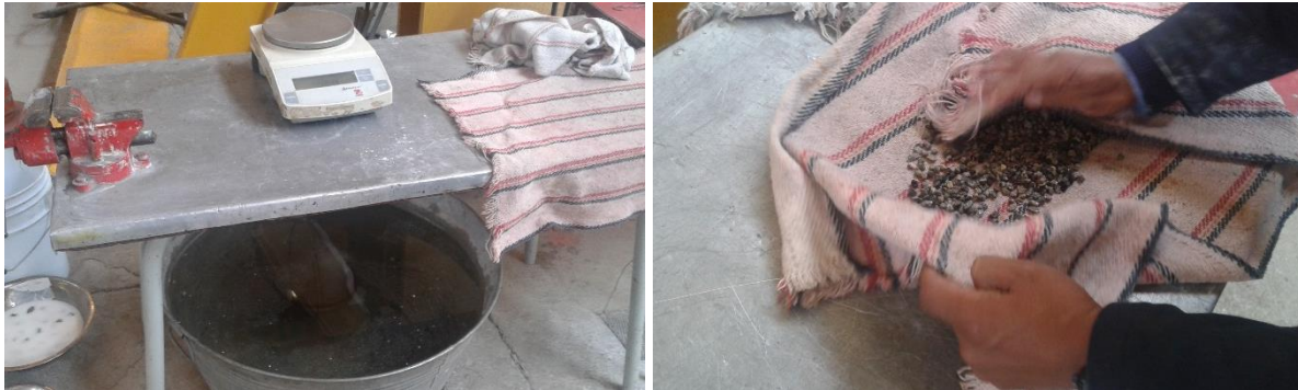
Figura 29. Ensayo a la Gravedad específica y absorción para la grava
