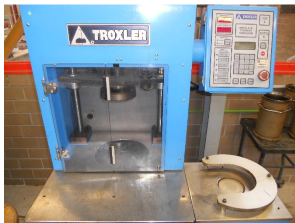
Figura 33. El compactador giratorio utilizado en esta investigación es de la marca TROXLER, modelo 4140
