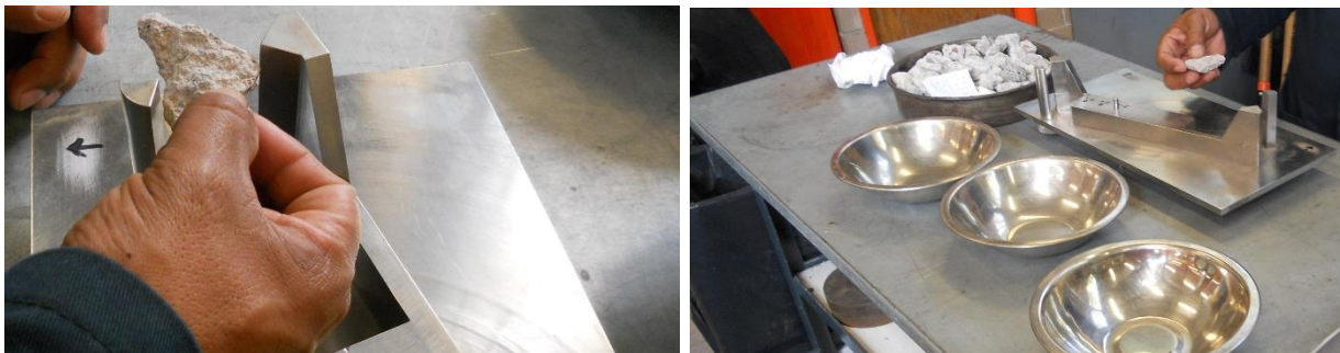
Figura 24. Se aplica a agregados gruesos mayores a la malla No. 4 (4.75 mm), para medir la relación de dimensiones de una muestra representativa de las partículas del agregado empleando un calibrador
