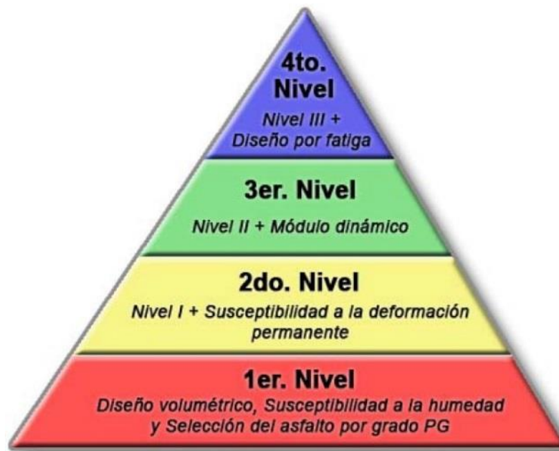
Figura 32. Niveles de diseño para una mezcla asfáltica densa
