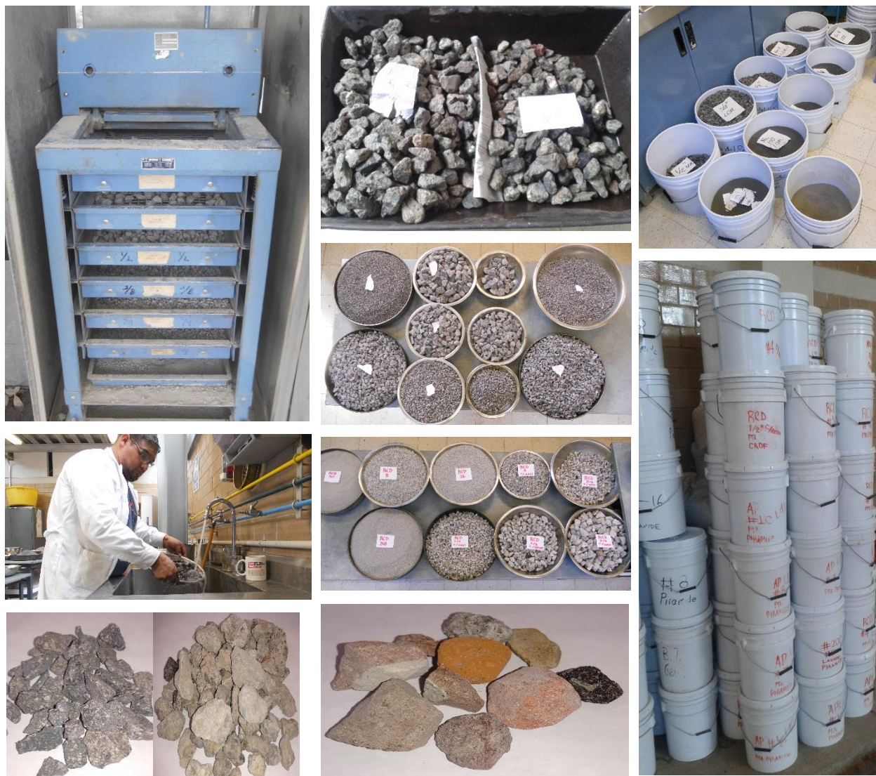
Figura 17. Tratamiento del agregado pétreo de cantera y RCD
