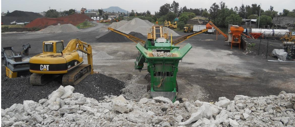
Figura 5. Procedimiento de reciclaje del material producto de RCD.
