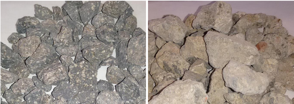
Figura 22. Se ejecuta sobre partículas gruesas retenidas en la malla No 4 (4.75 mm), una cara fracturada es una cara que expone el interior de la partícula
