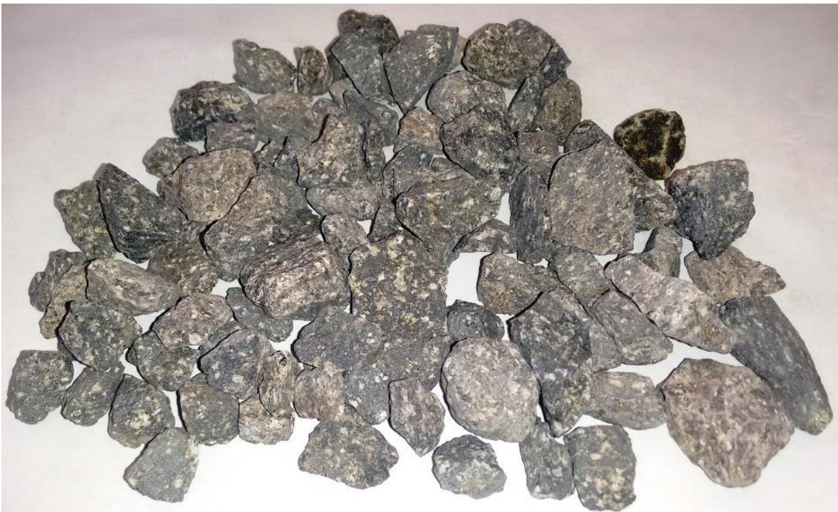
Figura 14. Agregado pétreo de cantera para esta investigación es un “Basalto”, procedente del banco del Grupo Constructor Pirámide
