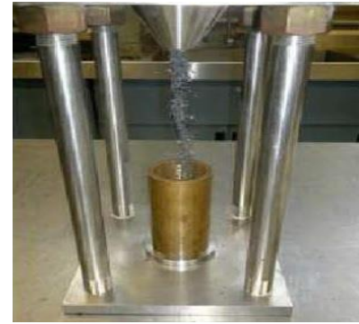
Figura 23. Prueba de la angularidad de agregado fino
