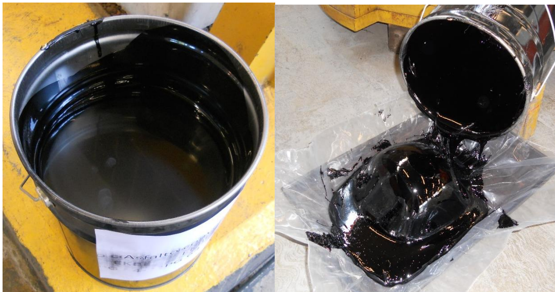
Figura 30. El cemento asfáltico utilizado en esta investigación es clasificado como PEMEX EKBÉ Superpave PG.
