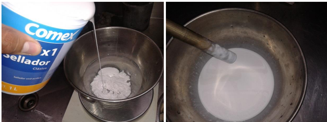
Figura 18. Se escogió el aditivo denominado “Sellador 5×1, Vinílico – Acrílico”, considerando sus componentes y consistencia, se utiliza mezclado con agua
