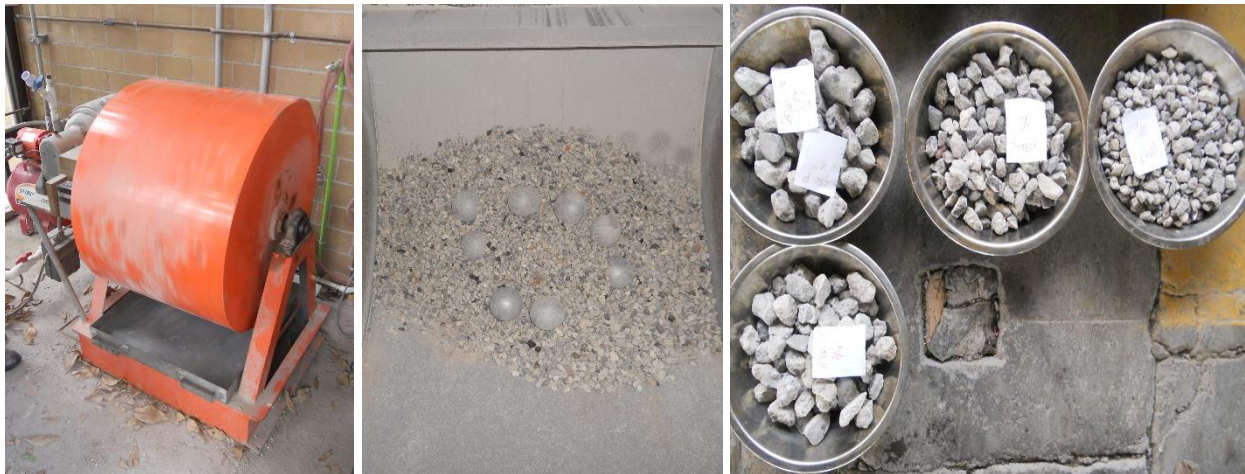
Figura 26. Ensayo de desgaste en la máquina de “Los Ángeles”
