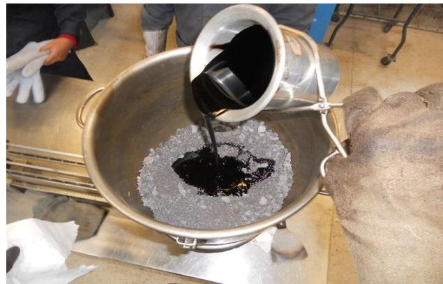
Figura 35. Determinación del porcentaje de cemento asfáltico
