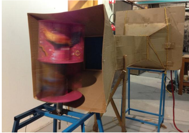
Figura 3.7 – Modelo final del túnel de viento abierto
