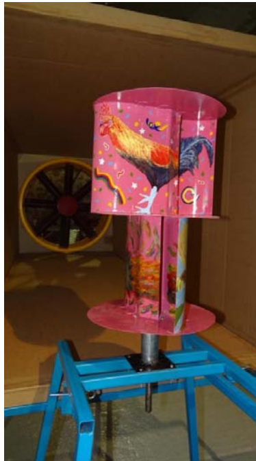
Figura 3.5 - Rotor "Piñata" ( \beta = 0.45 ) montado sobre el eje y la base
