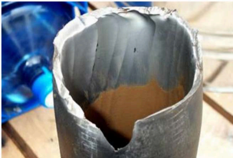
Figura 13 Corrosión por SSC
