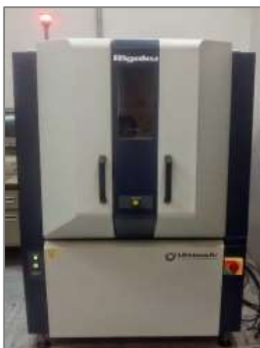
Figura 3-5. Difractómetro Rigaku ULTIMA IV.
