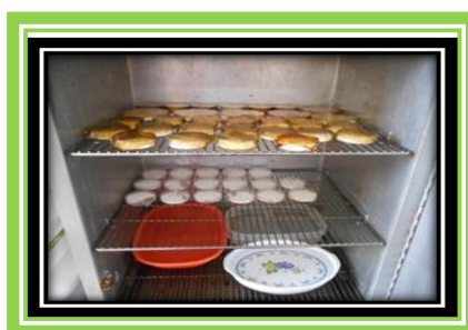
Figura 12. Prueba de permeabilidad al vapor de agua.
