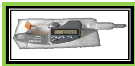
Figura 11. Medición de espesor de envase activo con un micrómetro Mitutoyo.
