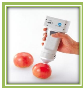
Figura 9. Medición de color de jitomate con Espectrofotómetro Minolta CM-600d.
