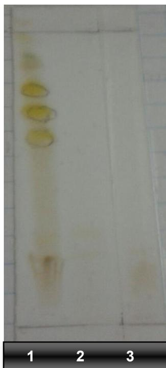
**Figura 4.** CCF de las particiones de AcOEt (1), 2-Butanol (2) y acetona (3) revelada con  $\text{AlCl}_3$
