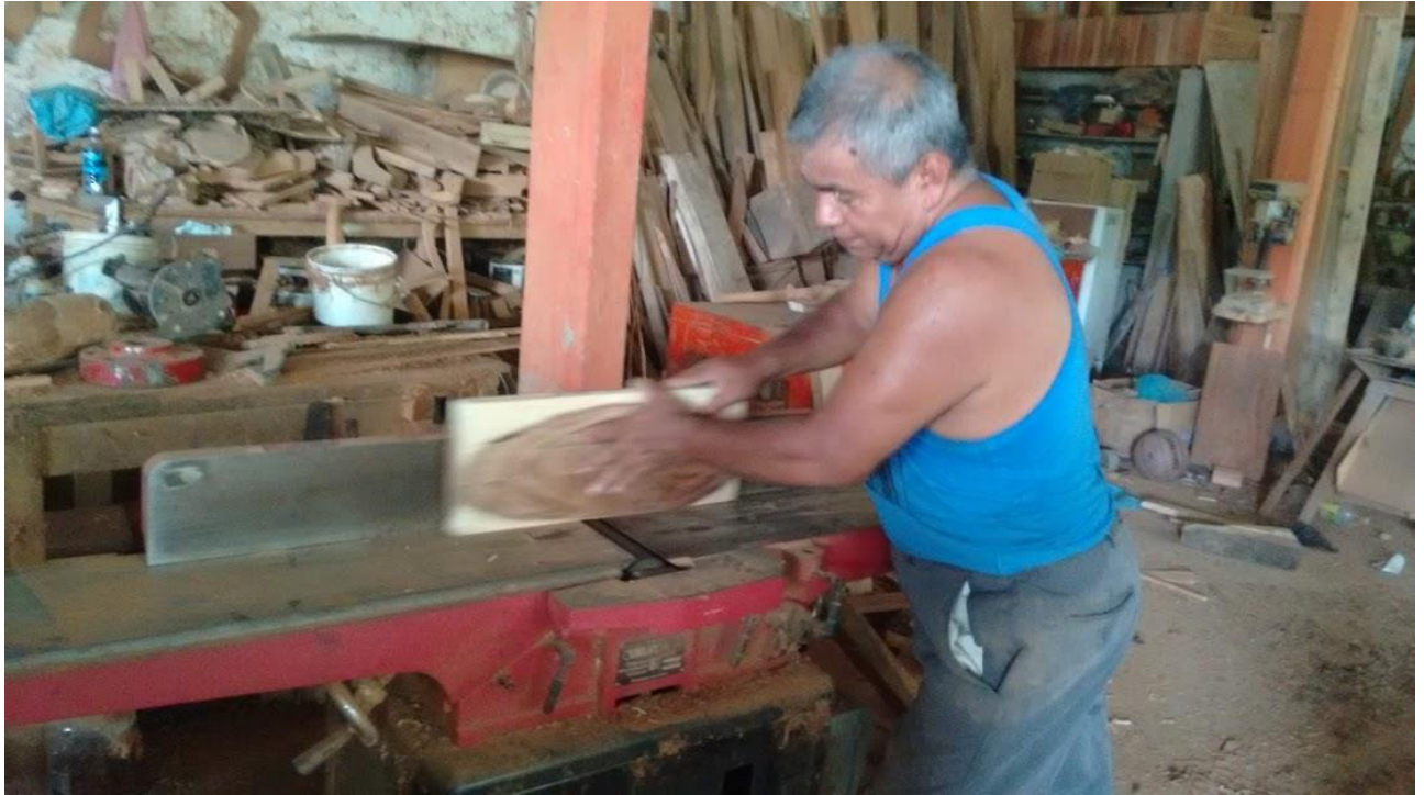
Figura 13 Maestro carpintero ilustrando la forma correcta de cepillar
