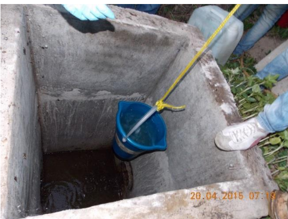
IMAGEN 9 RECOLECCIÓN DE MUESTRA Y MEDICIÓN DE GASTO
