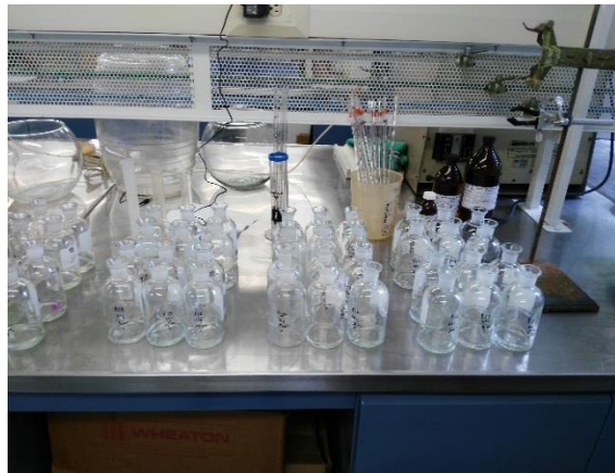
L) PREPARACIÓN DE FRASCOS WINKLER PARA LA DETERMINACIÓN DE LA DBO 5
