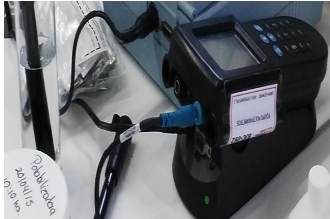
FIGURA 15 MULTIPARÁMETRO UTILIZADO PARA LA MEDICIÓN DE PARÁMETROS IN SITU
