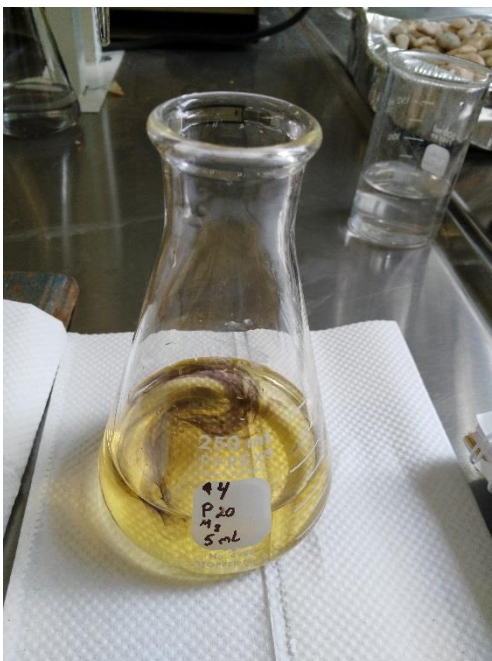
Ñ) DETERMINACIÓN DE OXÍGENO DISUELTO POR TITULACIÓN, ADICIÓN DEL INDICADOR
