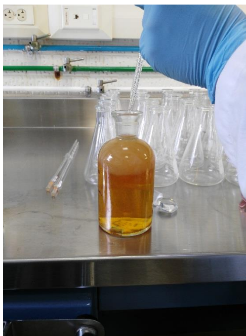
N) ADICIÓN DE DISOLUCIONES PARA FIJAR EL OXÍGENO DISUELTO
