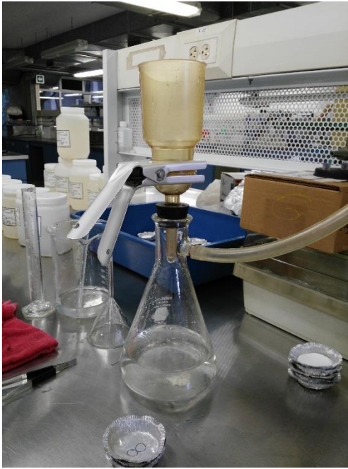
I) FILTRACIÓN PARA LA DETERMINACIÓN DE SÓLIDOS SUSPENDIDOS TOTALES
