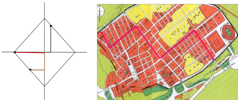
FIGURA 2.1.2. Ejemplo de la utilidad que tiene la Distancia Manhattan .
