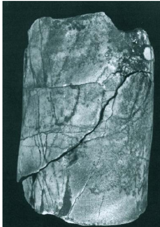
Fig. 1.3. Fotografía del núcleo de la arenisca Gargaf (Cámbrico- Ordovícico), cuenca Sirte, Libia, ilustrando la porosidad de fractura (Richard C. Selly, 2000).
