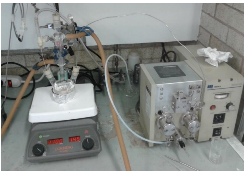
Figura 8. Sistema de reacción semicontinuo para prueba preliminar.
