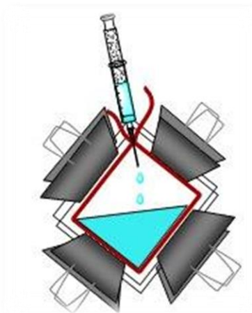
Figura 11. Adición de reactivos sistema de reacción placas.
