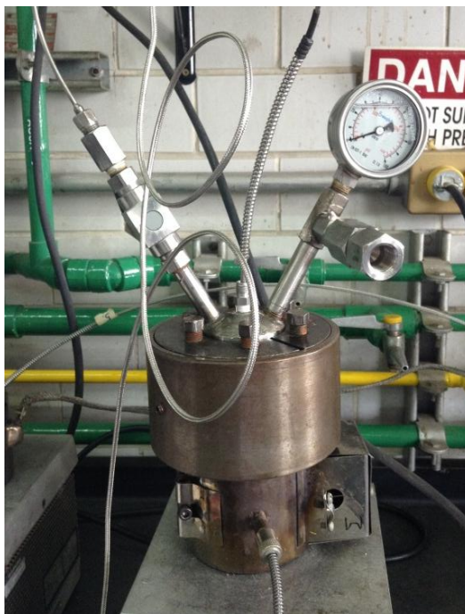
Figura 5.3 Reactor de 100 mL utilizado para la extracción con CO 2 supercrítico.
