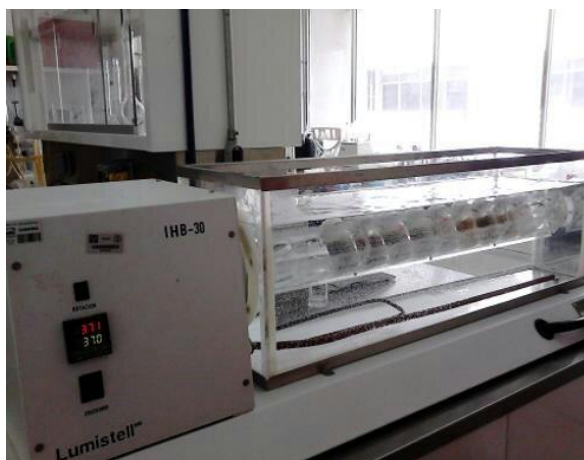
Figura 11. Equipo extractor construido para realizar el procedimiento para caracterizar la toxicidad del lixiviado del método SBRC (la imagen de lado izquierdo fue tomada de DOF, 2007)
