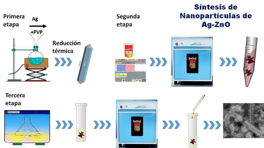
Figura 2.3 Proceso de síntesis y purificación de nanopartículas pentagonales de Ag-ZnO.
