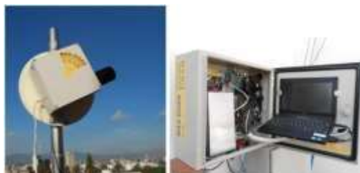
Fig. 41. Perfilador de gases MAX-DOAS de la UNAM. [19]
