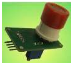
Fig. 46. Módulo de CO con el sensor MQ-7. [27]
