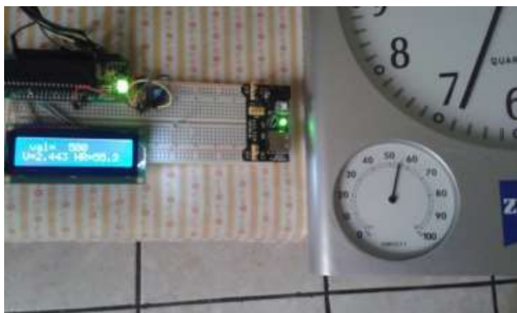
Fig. 109-c. Pruebas del sensor de humedad contra uno analógico comercial.
