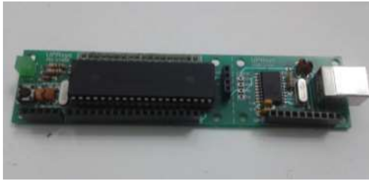
Fig. 111. Circuito impreso con microcontrolador PIC 16F887 e interfaz USB desarrollado por el M en I Ulises Peñuelas.
