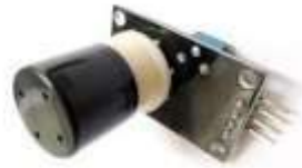
Fig. 47. Módulo detector de O 3 con el sensor MQ-131. [28]
