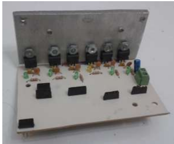
Fig. 110-d. Manufactura de la etapa de regulación.
