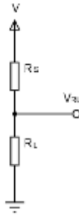
Fig. 83. Divisor de voltaje entre la resistencia del sensor y la de carga, donde R_S es la resistencia del sensor, R_L la resistencia de carga, V el voltaje de alimentación y V_{RL} el voltaje en la resistencia de carga.
