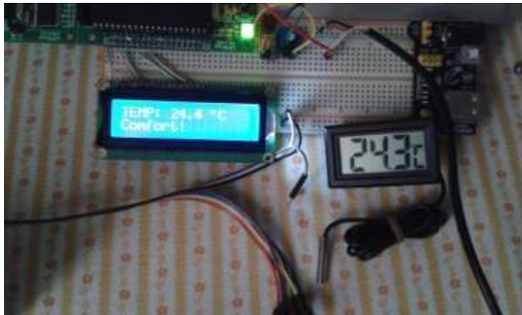
Fig. 109-b. Pruebas del sensor de temperatura contra uno digital comercial.
