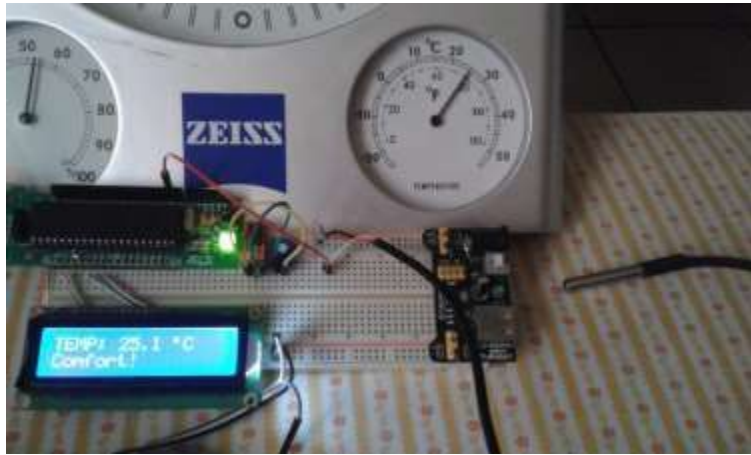
Fig. 109-a. Pruebas del sensor de temperatura contra uno analógico comercial.
