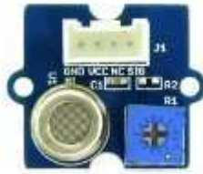
Fig. 44. Módulo de VOC's con el sensor WSP2110. [25]
