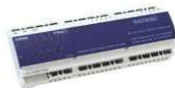
Fig. 55. Banco de relevadores de 4 canales. [37]
