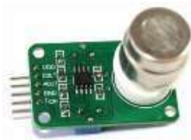
Fig. 45. Módulo de CO 2 con el sensor MG-811. [26]
