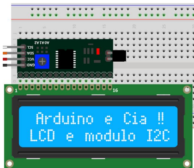
Ilustración 18. Esquema de conexiones de modulo I^2C a LCD. 23
