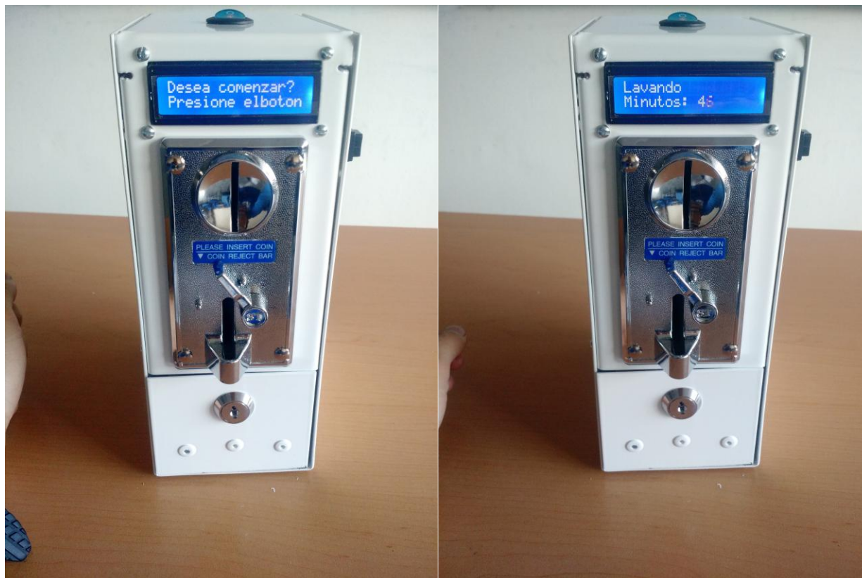
Ilustración 53. Ciclo de trabajo del prototipo, inicio de lavado. 41
