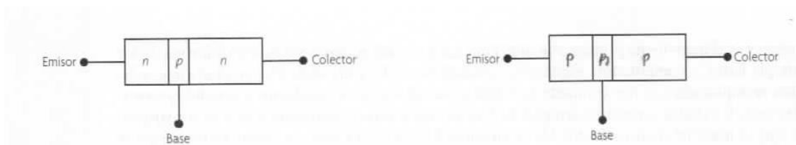
Ilustración 4. Regiones dopadas de los transistores. 9
