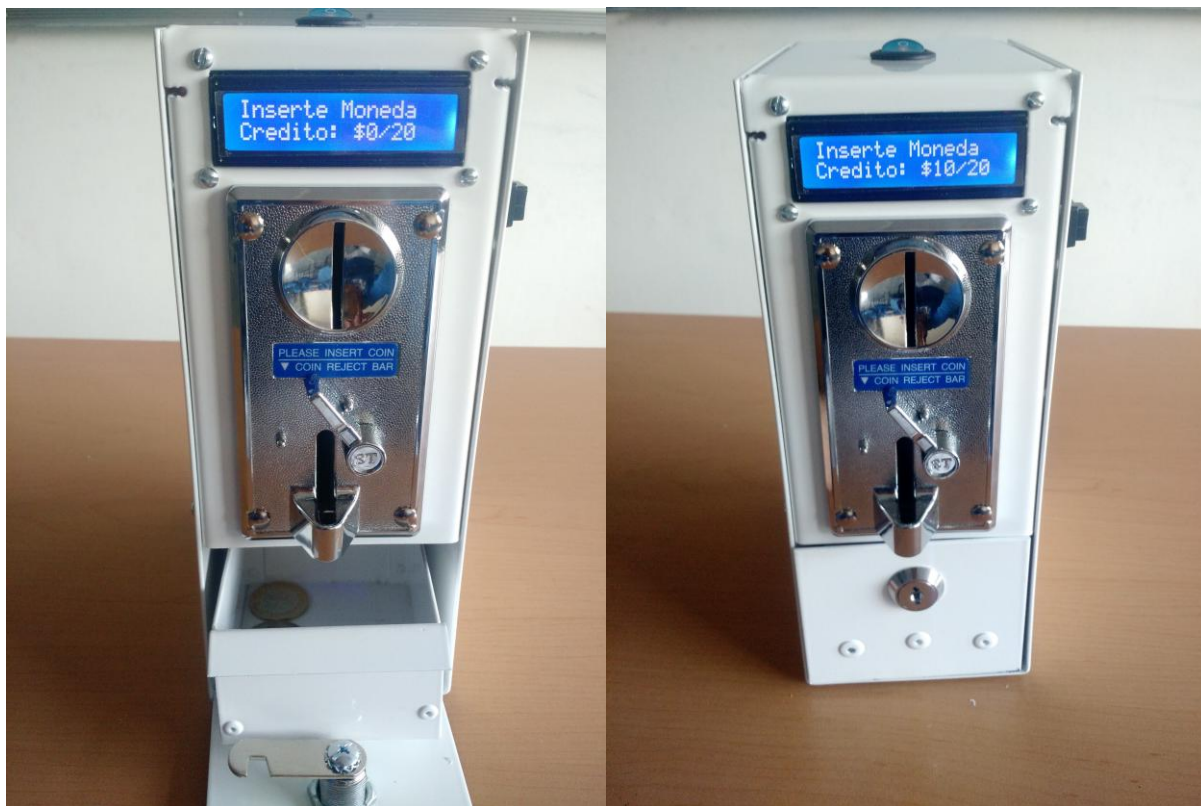
Ilustración 52. Ciclo de trabajo del prototipo, recepción de monedas.
