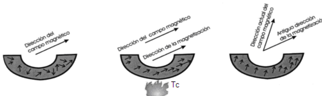
Figura 3.1. Proceso de adquisición de TRM en un horno (Soler-Arechalde, 2006).
