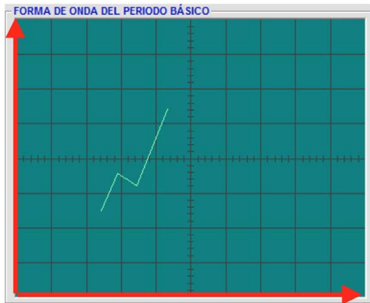
Figura 4.1: Pantalla virtual donde se define la forma de onda
