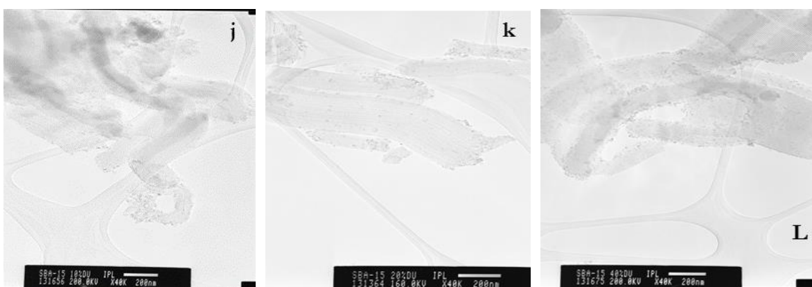
Fig. 4.22 Micrografías de los catalizadores impregnados con \text{TiO}_2 adicionado durante la síntesis del SBA-15, j) 10%, k) 20% y L) 40% en masa respectivamente
