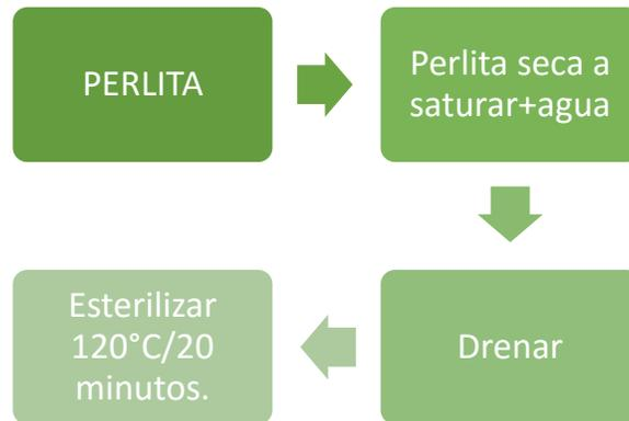
Figura 3.3 Esquema general de preparación de perlita.
